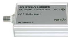
Bausatz für einen Splitter/Combiner für Frequenzen zwischen 0,5 MHz und 400 MHz. Eingangsleistung bei Einsatz als Splitter max. 1 W. Lieferumfang: Platine, ADP-2-1+ von Mini-Circuits, 3 BNC-Buchsen, bearbeitetes Aluminiumgehäuse und ausführliche Anleitung.
