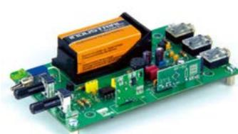
Bausatz für einen ISM-Transceiver für die drahtlose CW-Kommunikation über kurze Entfernen. Lieferumfang: Platine, alle Bauteile, Batterie sowie ausführliche Bauanleitung. Die ISM-Sende- und -Empfangs-module müssen aus rechtlichen Gründen separat erworben werden.
