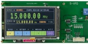
Universell für Eigenbauprojekte mit 21,4-MHz-ZF einsetzbar. Entwickler Heinz Stampfl, HB9KOC Frequenzbereich 21,5...51,4 MHz Abstimmsschritte umschaltbar 10, 100 Hz, 1, 5, 9, 100 kHz, 1 MHz Stabilität (0...60 °C) 1 ppm Betriebsspannung 9...16 V Platinenabmessung 110 x 50 mm Beschreibung siehe FA 6/2021
