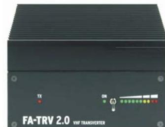
Der Jahr 2021 von Uwe Richter, DC8RI, weiterentwickelte Transverter ist rauschärmer als sein Vorgänger und gegen versehentliches Senden in den ZF-Ausgang geschützt. Hinzugekommen ist eine Anzeige für die Temperatur des Kühlkörpers.
