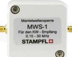
Frequenzbereich 0,15 bis 30 MHz. Hilfsmittel zur Empfangsverbeserzung. Nicht zum Senden geeignet. Einfügedämpfung < 1 dB Anschlüsse SMA Schutzart IP6 Abmessungen (ohne Buchsen) 53 x 53 x 36 mm
