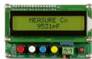
Einbaufertiges, geprüftes LC-Meter-Modul mit beleuchtetem Display. Messbereiche: 1 pF-10 μF, 1 nH-100 H, Stromversorgung +5 V/20 mA über USB- oder DC-Buchse
