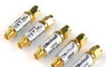
50-Ω-Dämpfungsglieder von für DC bis 6 GHz. Stecker/Buchse (m/f) Input maximal 1 W VSWR ≤ 1,2 @. Lieferbar mit 3, 6, 10, 20, 30 und 50 dB Dämpfung. Auch als 5er Satz (3/6/10/20/30)
