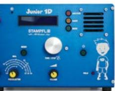
Kurzwellenempfang von 1,5 bis 30 MHz, AM und DSB. Abstimmung mit 10-Gang-Poti. Digitale Frequenzzanzeige und manueller Preselektor. Der Testbericht dazu wurde im FA 10/2017 veröffentlicht. Bauanleitung downloadbar auf [www.box73.de](http://www.box73.de)
