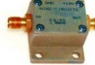
Für Messzwecke und andere Anwendungen. Verstärkung typ. 13 dB, SMA-Buchsen, Maße 26 x 27 x 15 mm Speisung 12 V/ 50 mA (NOS) DC 0009 Listenpreis \$ 124,95 ZJL-6G 93,-
