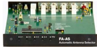
Der FA-AS ermöglicht es, vier Antennen anzuschließen und je nach Betriebsfrequenz über die analoge Bandspannung oder CI-V automatisch zu wählen. Er eignet sich außer für den IC-7300 auch für alle modernen Icom-TRX.
