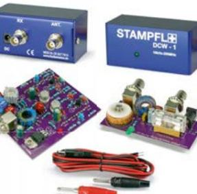
Bausatz von HB9KOC für einen Verstärker inkl. Fernspeiseweiche zum Anschluss an einen verkürzten Empfangsdipol. Die Schaltung ist für Dipolelemente mit 0,5 bis 1 m Länge ausgelegt. Lieferumfang: bestückte Verstärkerplatine, aufgebauter DCW-1-Fernspeiseweiche, Koaxialbuchsen und DC-Kabel sowie ein Faltblatt mit Schaltplan, Messwerten und Aufbauhinweisen. Dipolelemente sowie das Gehäuse für die Verstärkerplatine werden nicht mitgeliefert.
