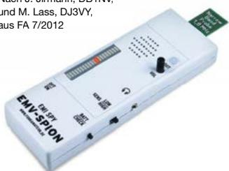
Handlicher Detektor zum Aufspüren von HF-Störquellen.
