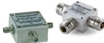
Für Messzwecke usw. innerhalb eines Frequenzbereichs von 100 kHz bis 2 GHz nutzbar. 20 dB Auskopplung, Einfügedämpfung typ. 0,7 dB. Ausführungen mit SMA- oder N-Buchsen im Sortiment. RoHS-konform
