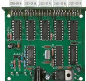
5-stelliges LED-Anzieldmodul, Auflösung 1 kHz, Betriebsspannung +5 V oder +7...18 V, Stromaufnahme max. 65 mA, 13 mm hohen LED-Siebensegment-Anzeigen, Hauptplatine 80 mm x 70 mm.
