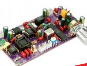
Bausatz von HB9KOC für eine universelle Baugruppe für Selbstbau-Empfängerprojekte bis 100 MHz Schaltungsprinzip Doppelsuperhet (21,4 MHz/455 kHz) Eingangsimpedanz 50 Ω Empfindlichkeit -117 dBm (AM, m=80%, B=6 kHz) Betriebsspannung 12 V Abmessungen 110 x 56 mm Beschreibung siehe FA 6/2021
