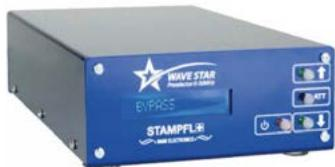
Komplettbausatz für einen hochwertigen Preselektor mit 8 umschaltbaren Filtern bis 30 MHz. Der Preselektor kann direkt von einem SDR Elad FDM-S2 gesteuert werden. Ein Bau- und Testbericht zum WAVE STAR wurde im FUNKAMATEUR 3/2022 veröffentlicht. Die 31-seitige Bauanleitung gibt es als PDF auf [www.box73.de](http://www.box73.de)
