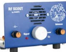
Einfachsuperhet zum Empfang des 31-m-KW-Rundfunkbandes. Speisung aus 3 AA-Batterien. Ein Bau- und Testbericht zum RF Scout wird demnächst im FUNKAMATEUR veröffentlicht. Bauanleitung als PDF auf [www.box73.de](http://www.box73.de)
